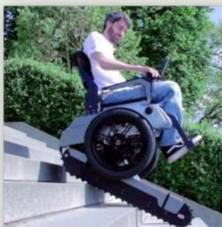
**Descrição:** Essa cadeira elétrica utiliza tecnologia giroscópica, para dar grande estabilidade e precisão – o que permite mudar de direção rapidamente e andar até 10km por hora sem riscos. Possui capacidade de subir e descer escadas com precisão e segurança; para fazê-lo, a cadeira aciona trilhos que se adaptam a declives de 17 a 34°.
