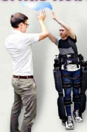
**Descrição:** O Rex (exoesqueleto robótico, em inglês) foi desenvolvido para ajudar pessoas com paraplegia a se locomover. Com as pernas robóticas, elas podem andar e até subir escadas. As pernas são controladas por um joystick e os movimentos são alimentados por uma bateria recarregável, que dura cerca de duas horas.
